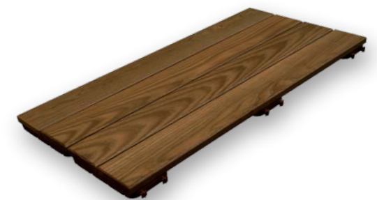
Tavole precomposte accoppiate in TERMO FRASSINO senza zigrinatura antiscivolo. Spess.31 x largh.199 x lungh.795 mm. Con supporto in resina. Pre-composed coupled boards in THERMO ASH smooth thickness 31 x width 199 x length 795 mm. With plastic resin grid base.
